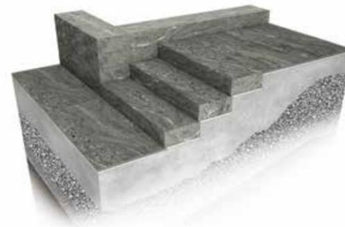
2\_\_\_ Auf Stahlbetonplatten verlegte Treppen und Treppenabsätze
