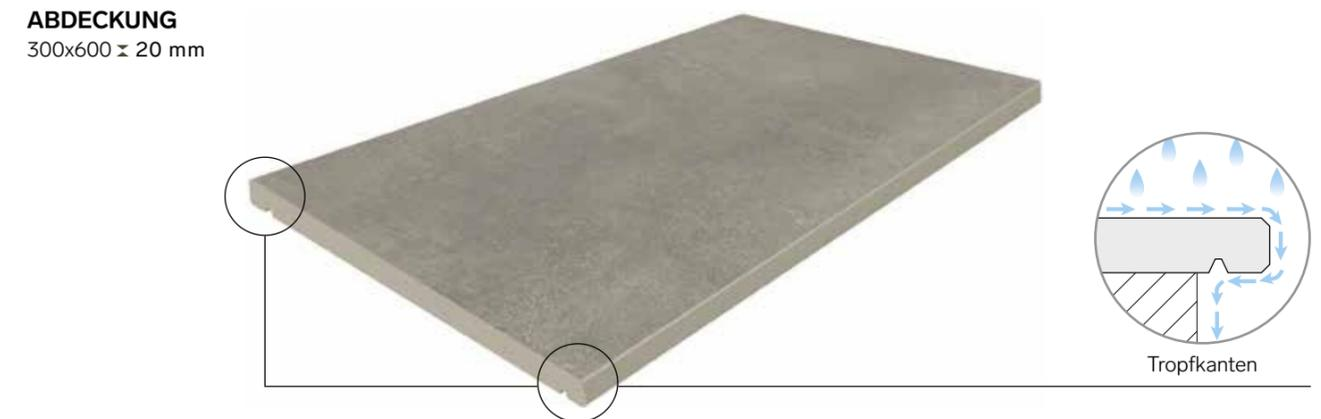
ABDECKUNG ist ein Formteil aus 20 mm dickem Feinsteinzeug, der nur an den kurzen Seiten geschliffen ist. Zum Verlegen bedarf es daher einer **4 mm breiten Fuge**.
