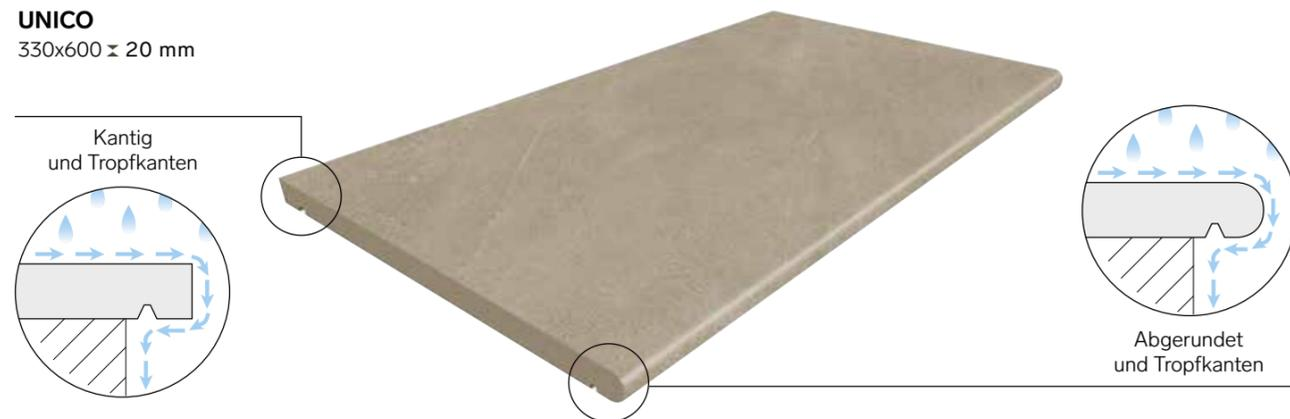
UNICO ist ein Formteil aus 20 mm dickem Feinsteinzeug, der nur an den kurzen Seiten geschliffen ist. Zum Verlegen bedarf es daher einer **4 mm breiten Fuge**.
